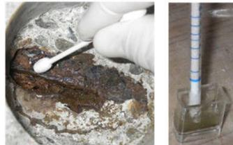
PC鋼材腐食の原因が塩化物
