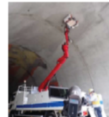
レーザー打音による変状の把握
