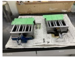
写真1-1-2 補修モルタル打込み前
