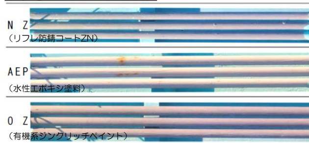
写真-2 丸鋼供試体の腐食状況（塩害暴露1年）
