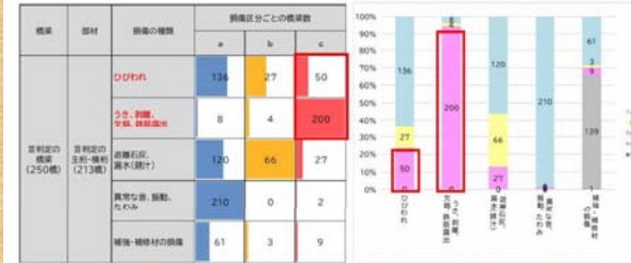
県判定の橋梁(主桁・横桁)は、「ひびわれ」や「うき、剥離、欠損、鉄筋露出」が判定となる場合が多い。
