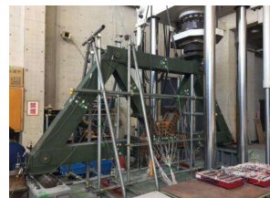
トラス格点腐食部補修実験
