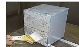
写真-1 供試体への表面含浸材の塗布状況
